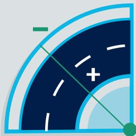
**Radio de curvatura:** El radio de curvatura determina la intensidad con que gira la vía en relación con la longitud que se recorre. El radio de curvatura a considerar es el predominante en el tramo analizado.
