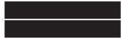
LÍNEA DE SEPARACIÓN DE CIRCULACIÓN (No debe ser traspasada ni circular sobre ella)
