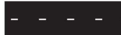
LÍNEA DE SEPARACIÓN DE SENTIDO DE CIRCULACIÓN (Indica la posibilidad de ser traspasada)
