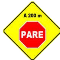
PROXIMIDAD DE SEÑAL RESTRICTIVA (Pare)
