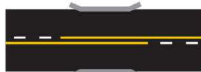
LÍNEAS CONTINUAS Y DISCONTINUAS PARALELAS (Línea discontinua del lado del carril que se circula: traspaso autorizado)
